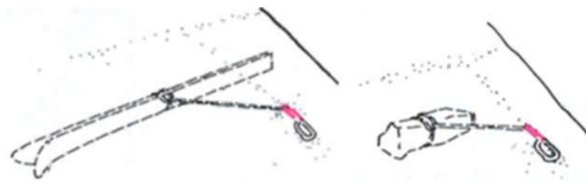
Figura 63. Anclaje en "T" realizado con un esquí y con un bloque de roca
