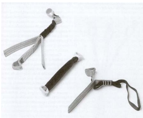
Figura 9. Disipadores de impactos para seguros dudosos (la funda está retirada para mostrar el tejido, tanto para protección en roca (la funda está en su lugar), como para aseguramiento en hielo poco fiable.
