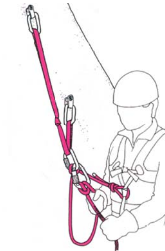
Figura 89. Aseguramiento al segundo con nudo dinámico en una reunión en hielo con triángulo de fuerza anudado
